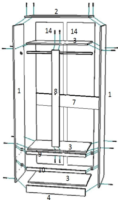
Прибить гвоздями опоры к детали 1. Шурупами 3,5\*16 привернуть направляющие в готовые наметки(колесом вперед) к деталям 1. В готовые отверстия детали 1 вставить шканты. К детали 1 шурупами привернуть штангодержатели. Еврошурупами скрепить детали 1, 2, 3, 4, 7, 8, (одновременно устанавливая детали 9 и 10) на шканты как показано на рисунке.
