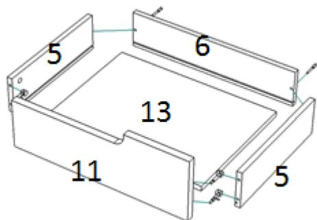
Еврошурупами скрепить детали 5 и 6. В пропил установить ЛДВП. В готовые отверстия детали 11 вернуть эксцентрики и скрепить замками с деталью 5. К нижней части детали 5 шурупами 3,5\*16 привернуть направляющие (колесом назад).
