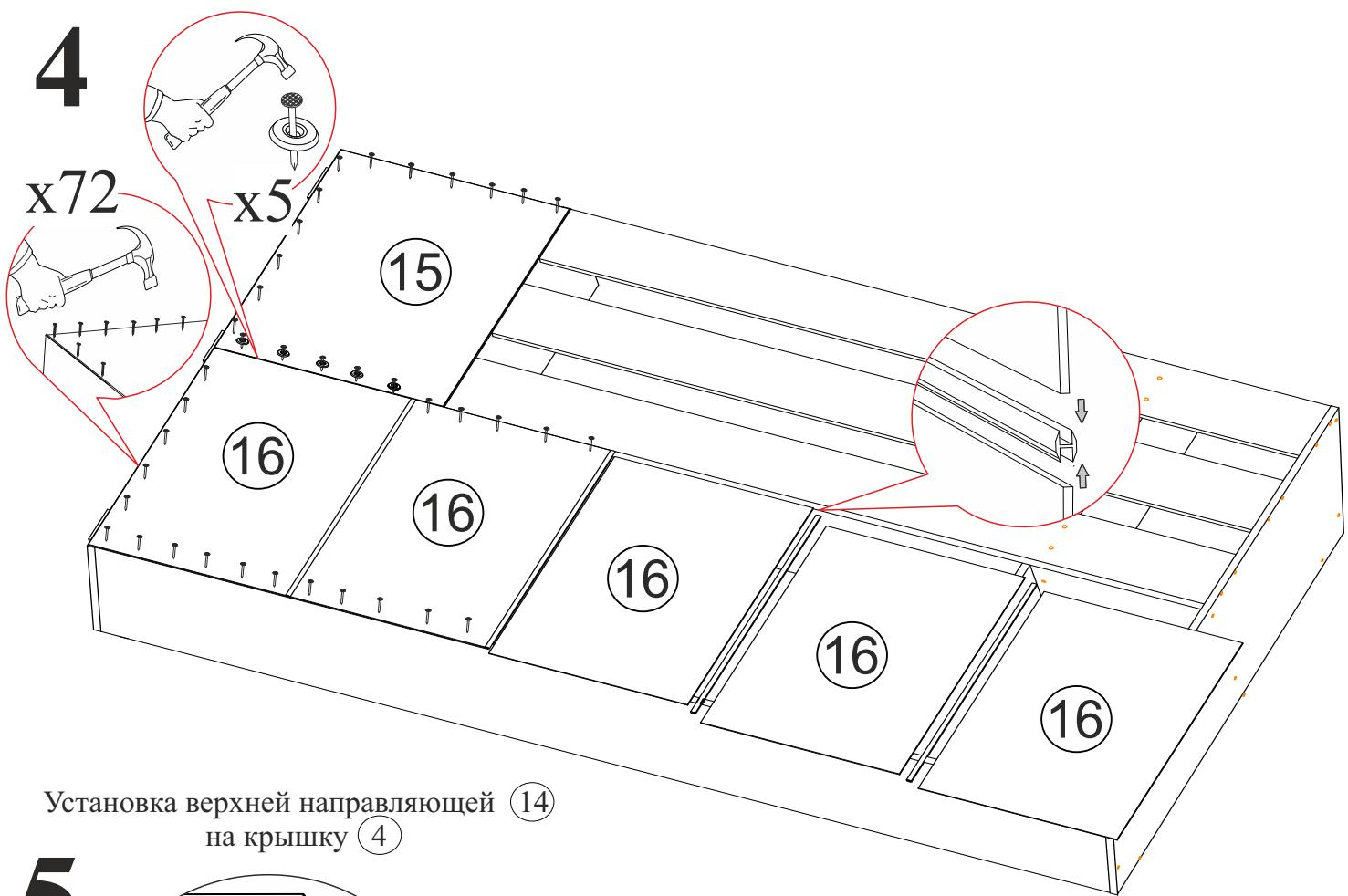
Установка верхней направляющей ⑯ на крышку ④
